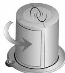
Lautsprecher in ausgefahrener Ausgangsposition. Lautsprecher in gewünschte Position drehen.
